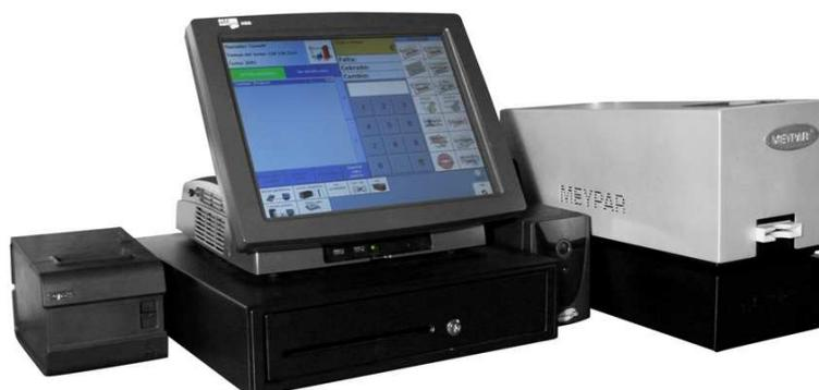
Desde el equipo de cobro manual (TPM o TPV) realizaremos los cobros de las estancias de los usuarios del parking de forma manual.
